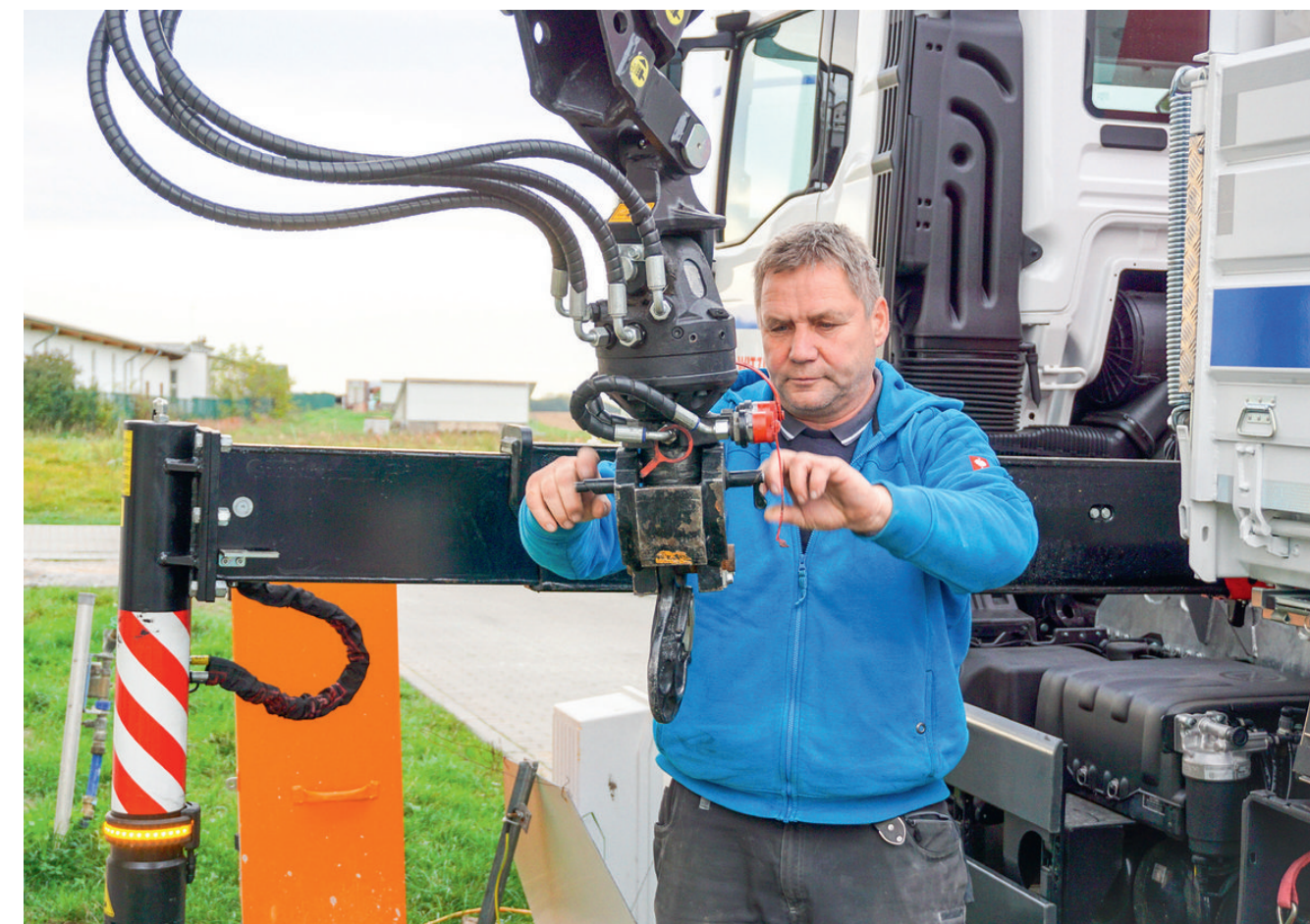
Karsten Müller hat die hydraulische Abstützung des MAN positioniert und wechselt nun am FASSI das Ladegeschirr
