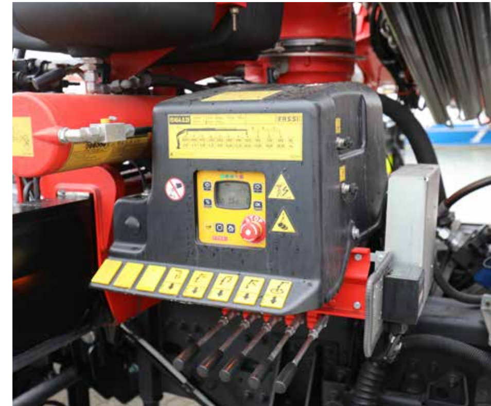
Kransäule des F245A.0.25 mit Steuerblock sowie Schwenkzylinder und ausgefahrener Abstützung
