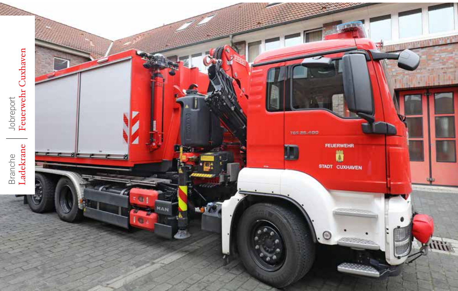
Der Neuzugang der Cuxhavener Berufsfeuerwehr mit Fassi F245 und Marrel AL16 im Innenhof der Hauptwache
